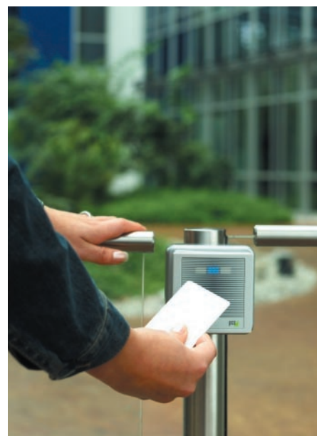
Zutrittskontrolle im Außenbereich an einem RFID-basierten kontaktlosen Lesesystem
