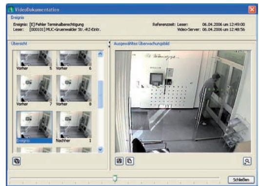
Bild 3: Per Videodokumentation werden mehrere Bilder vor und nach dem Ereignis aufgezeichnet.
