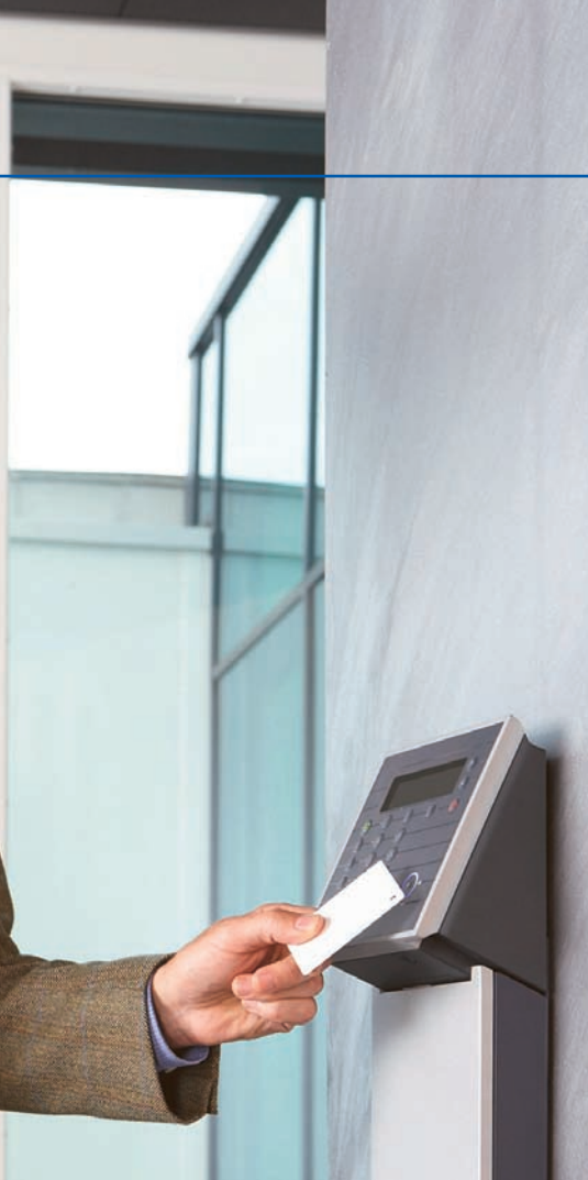
Bild 1: Kontaktlose Personenidentifikation mit kontaktloser Chipkarte an einem kombinierten Zutritts- und Zeiterfassungsterminal mit hinterlagter Videoüberwachung.
