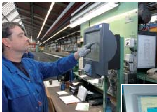
Die BDE-Applikation bei Erbslöh ist so aufgebaut, dass die Icons auf dem Monitor auch mit Handschuhen angestoßen werden können
