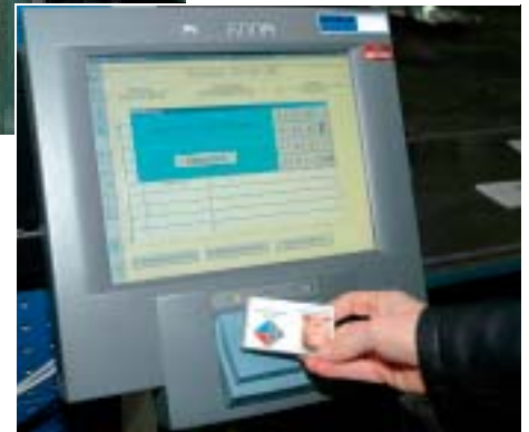
Die Terminals sind mit einem Kombileser ausgestattet. Dieser liest sowohl die Mitarbeiterausweise als auch die Barcodes der Arbeitspapiere (Bilder: Autor)
