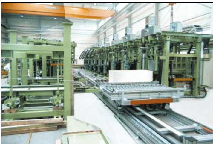
Typisches Produkt der Schäumtechnik sind Kühlschrankgehäuse, hier eine Anlage mit Doppelquerverschiebewagen.
