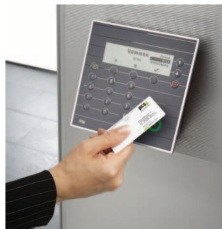
Bild 3: Beispiel für ein Design prämiertes PZE-Terminal der neuesten Generation mit kontaktlosem Lesesystem und Bedienung über eine Multifunktionsanzeige (MagicEyes). Die Personenidentifikation erfolgt quasi im Vorbeigehen. (Foto: PCS Systemtechnik)
