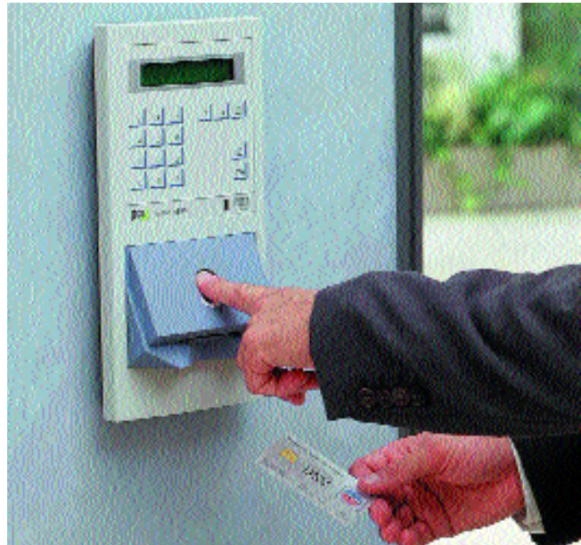
Bild 3: Das Terminal kombiniert die Kontrolle per Fingerabdruck mit einem Chipkartenleser für die Geldkarte.
