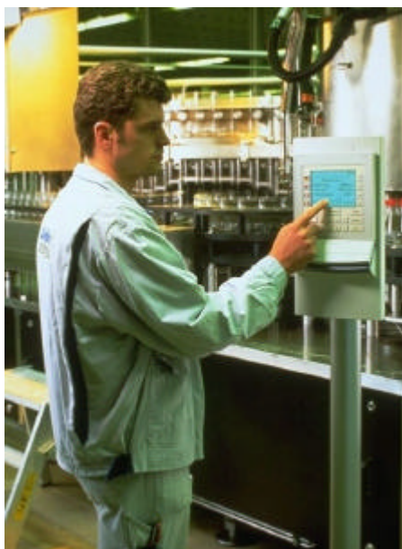
Abbildung 2: Betriebsdatenerfassung an einem Terminal mit Touchdisplay.
