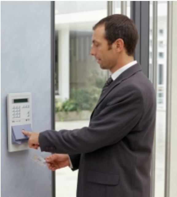
Bild 3: Beispiel für ZK- und PZE-Terminal mit Fingerprint in Kombination mit einem Chipkartenleser
