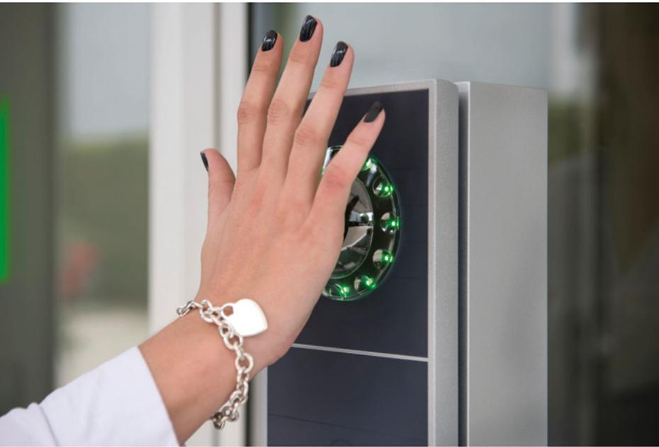
Abb. 3: Biometrische Zutrittssteuerung mittels Handvenenerkennung
