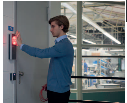
Vor dem Serverraum meldet sich der Mitarbeiter mit seiner RFID-Karte an und verifiziert über die Handvenenerkennung die Identität seiner Person.
