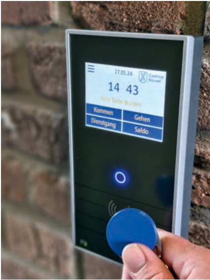
Bild 2: Die Oberfläche des Zeiterfassungsterminals »Intus 5200« ist mit dem Wappen der Stadt und farbigen Funktionstasten entsprechend dem geltenden Farbkonzept versehen
