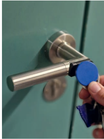
Bild 3: Die mechatronischen Türdrücker »Intus Flex« von PCS übernehmen die Zutrittskontrolle im denkmalgeschützten Forum von Castrop-Rauxel
