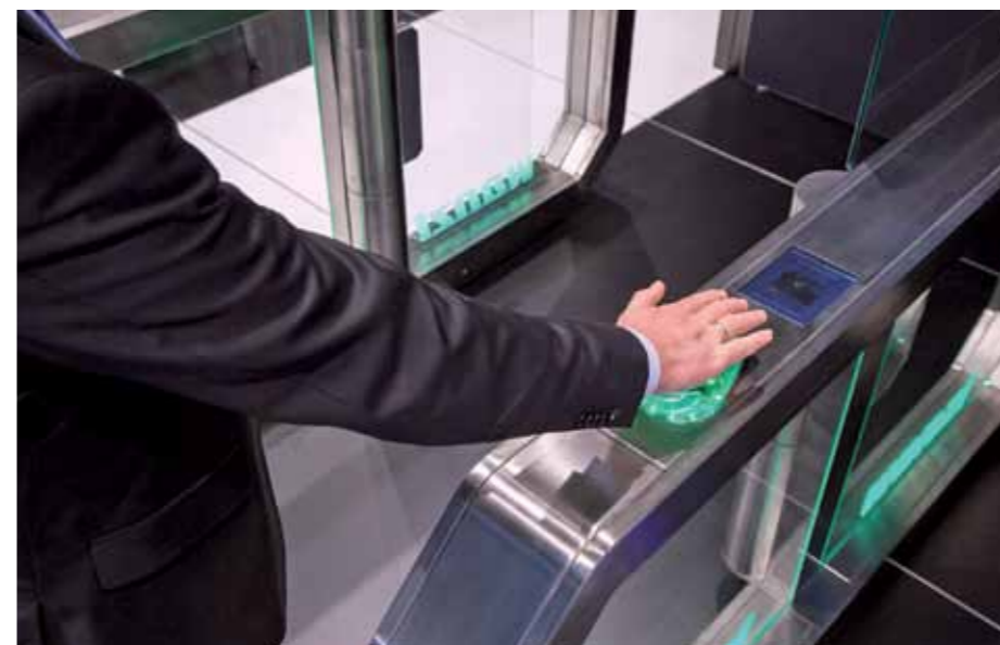
▲ Der Handvenensensor kann als Einbaumodul auch in Einzelanlagen integriert werden. Foto: PCS Systemtechnik GmbH
