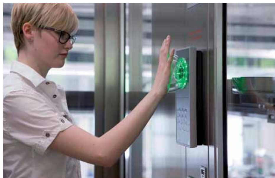
▲ Für eine 2-Faktor-Authentifizierung lässt sich die Handvenenerkennung mit PIN oder RFID-Ausweis kombinieren. Foto: PCS Systemtechnik GmbH
