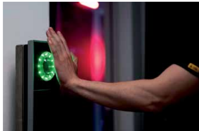
▲ Biometrische Handvenenerkennung ermöglicht sichere Zwei-Faktor-Authentifizierung in Hochsicherheitszonen. Foto: PCS Systemtechnik GmbH
